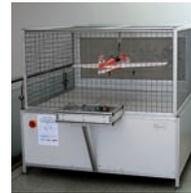
Der Studiengang Technik hat im letzten Jahr einen Flugsimulator für eine Ausstellung des Landesmuseums für Kunst und Kulturgeschichte Oldenburg gebaut. Gezeigt wird ein Windkanal, in dem ein Modellflugzeug mit einer Spannweite von 1,20 Meter per Fernlenkung fliegen kann.
